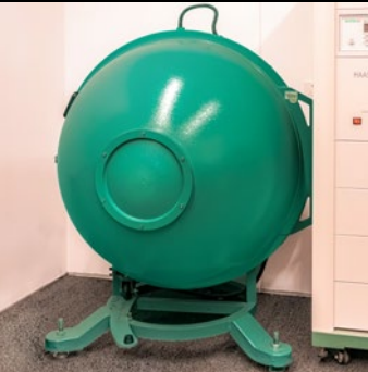
光通量测试 采用积分球系统，精准评估光通量、色温等参数。
