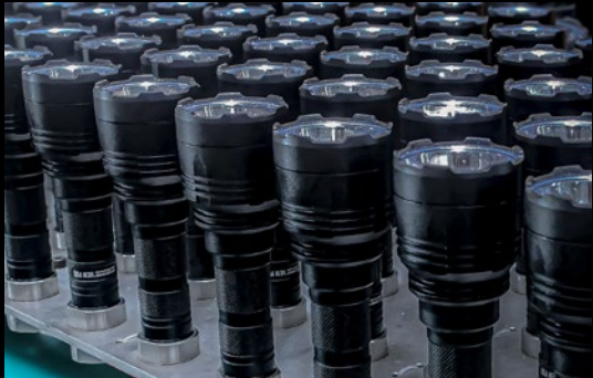
老化测试 设备调到最高输出模式并通过模拟长时间使用条件下，验证产品的可靠性，提高产品出货品质。
