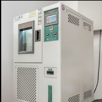
高低温环境测试 使用恒温恒湿试验箱，测试产品在极端的温度湿度环境下使用的性能表现。
